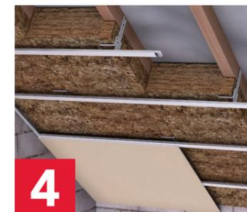
4 Mise en œuvre de l'ossature secondaire et de la finition.
