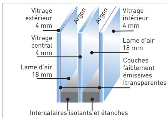
Composé de 3 vitres et 2 lames d'air, il est plus isolant thermiquement qu'un double vitrage mais plus lourd et moins lumineux. Son utilisation peut s'avérer judicieuse pour des fenêtres exposées au nord.
