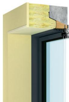
**Isolation thermique par l'extérieur (ITE)**
