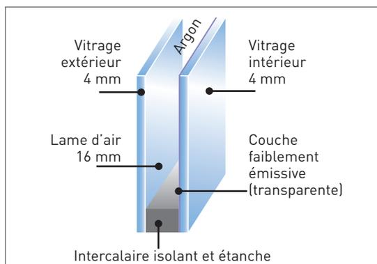
Double vitrage isolant avec un « traitement très basse émissivité » (TBE). C'est une couche métallique transparente sur une face intérieure qui lui permet d'être 50 % plus isolant (Ug 1,1) qu'un double vitrage classique. De série chez K•LINE.
