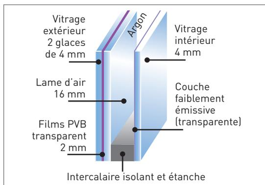
Le vitrage extérieur est composé de plusieurs feuilles de verre collées entre elles par un film plastique transparent. Lorsque le verre se brise, les fragments restent maintenus ensemble (principe du pare-brise de voiture).
