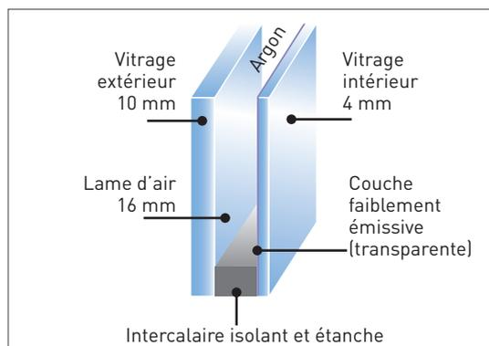
L'isolation acoustique dépend de la différence d'épaisseur entre les 2 vitres et la largeur de lame d'air. L'utilisation d'un vitrage feuilleté renforce également l'isolation acoustique.
