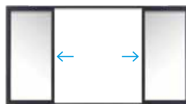
4 VANTAUX 2 RAILS largeur jusqu'à 5,80 m
