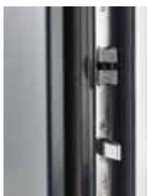
SERRURE À GOUJONS 6 POINTS EN OPTION 2 GOUJONS, 3 PÊNES 1/2 TOUR ET 1 PÊNE DORMANT CONFORME CLASSE SÉCURITÉ RC2
