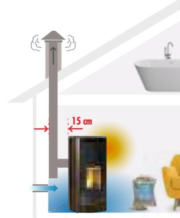
↓ Installation avec Upper Smoke Technology coaxial
