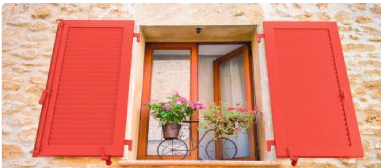
Volets battants à cadre en alu extrudé, lames persiennes ajourées à l'américaine avec espagnolette Cubique. Coloris : rouge feu RAL 3000 et quincailleries assorties en option.
